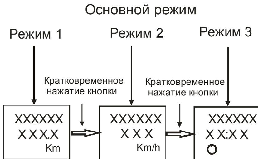
1-я строка на жидкокристаллическом дисплее отображает численное значение общего пробега автомобиля в километрах (данные, представленные в этой строке не могут быть изменены потребителем);
