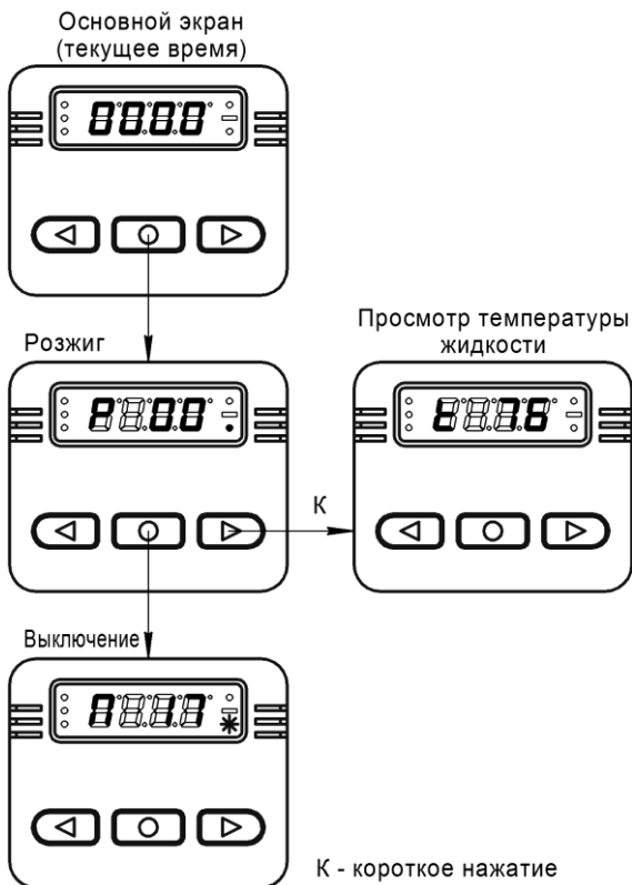
Рис.4.8 – Запуск подогревателя 14ТС-10
