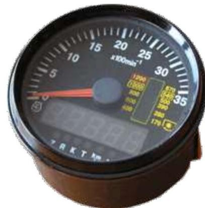
Индикатор приме Индикатор комбинированный электронный КД8083 (в дальнейшем индикатор), предназначен для контроля скорости движения, частоты вращения коленвала двигателя, суммарного времени работы двигателя, а также для индикации частоты вращения двухскоростного независимого вала отбора мощности (ВОМ) и пульт управления КД8083-П (в дальнейшем пульт), предназначенный для программирования переменных параметров индикатора.
