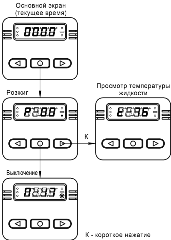
Рис.4.8 – Запуск подогревателя 14ТС-10
