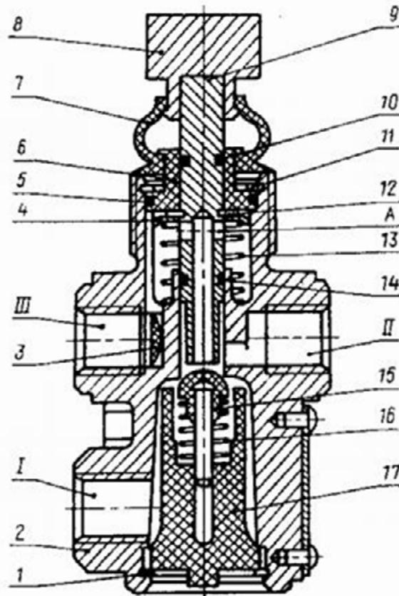
1,11,12 – уплотнительные кольца; 2 – корпус; 3 – фильтр; 4 – тарелка пружины; 5,10,14 – уплотнительные кольца; 6 – втулка; 7 – защитный чехол; 8 – кнопка; 9 – толкатель; 13 – пружина толкателя; 15 – клапан; 16 – пружина клапана; 17 – направляющая клапана;
