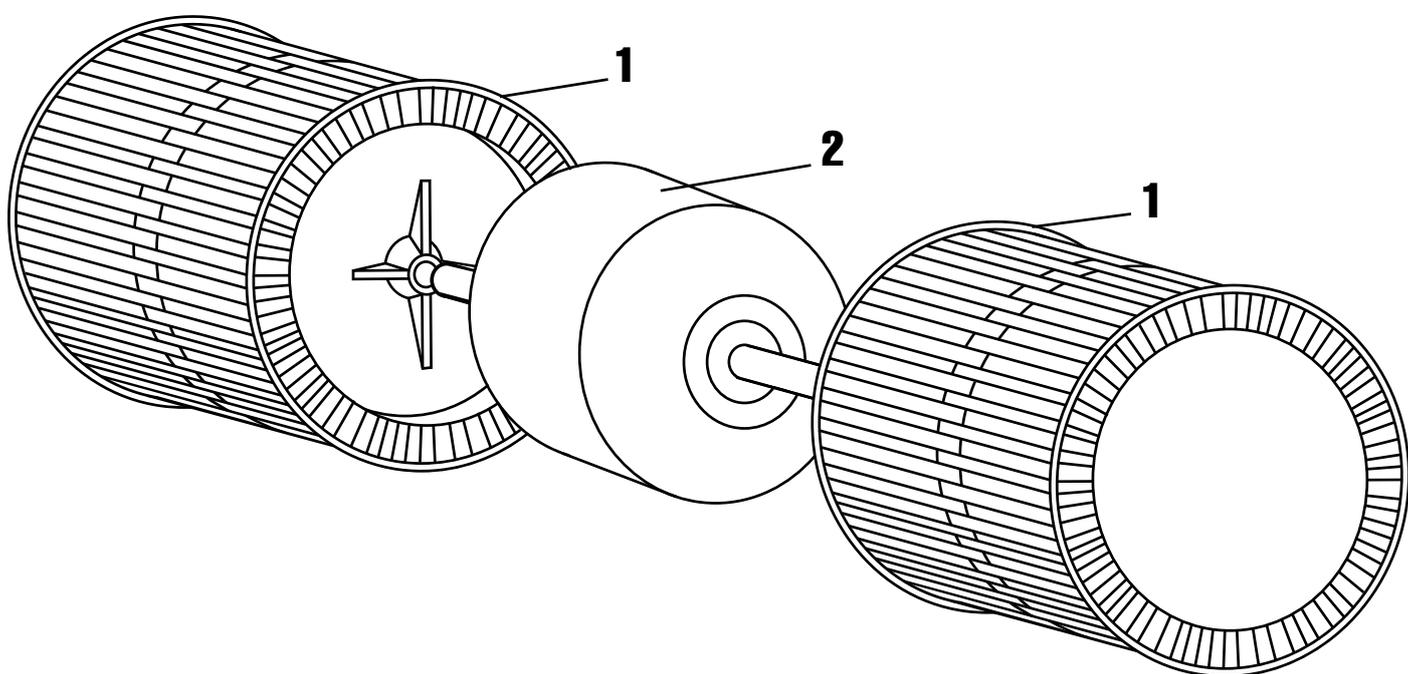
1 - крыльчатка, 2 - электродвигатель.
